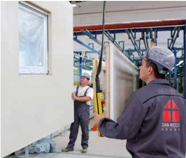
Die Wände werden in der Fabrik vorgefertigt...
